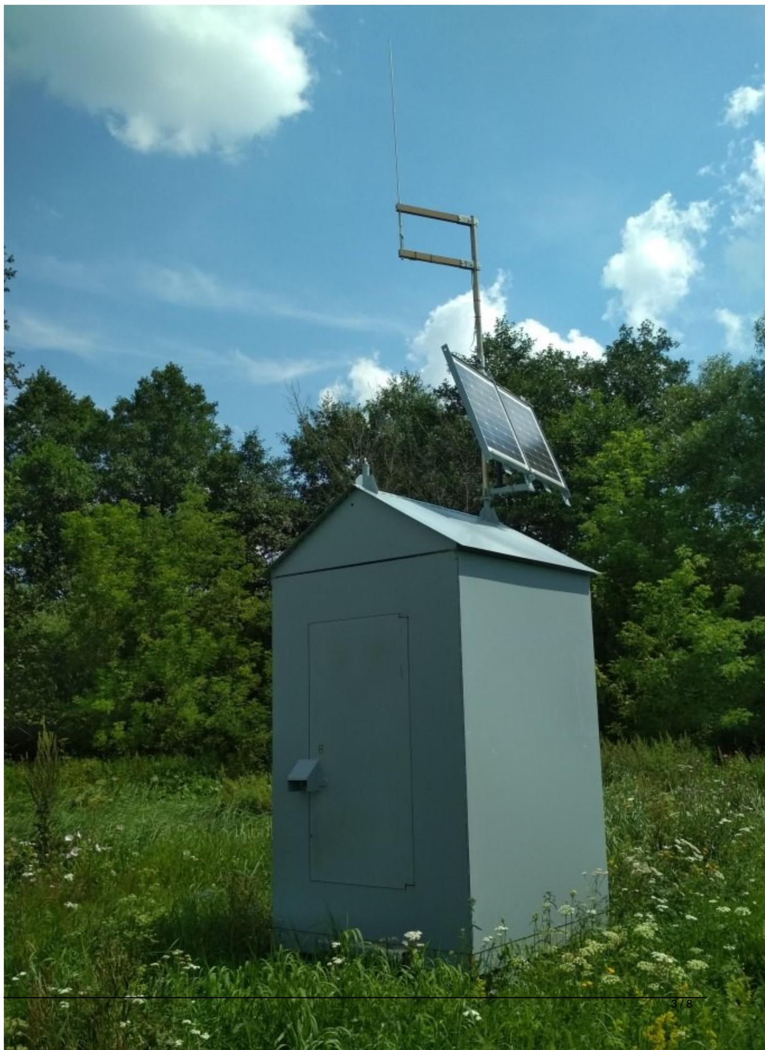
Рис. 2. Автономный гидрологический пост р. Уза-с. Чардым
