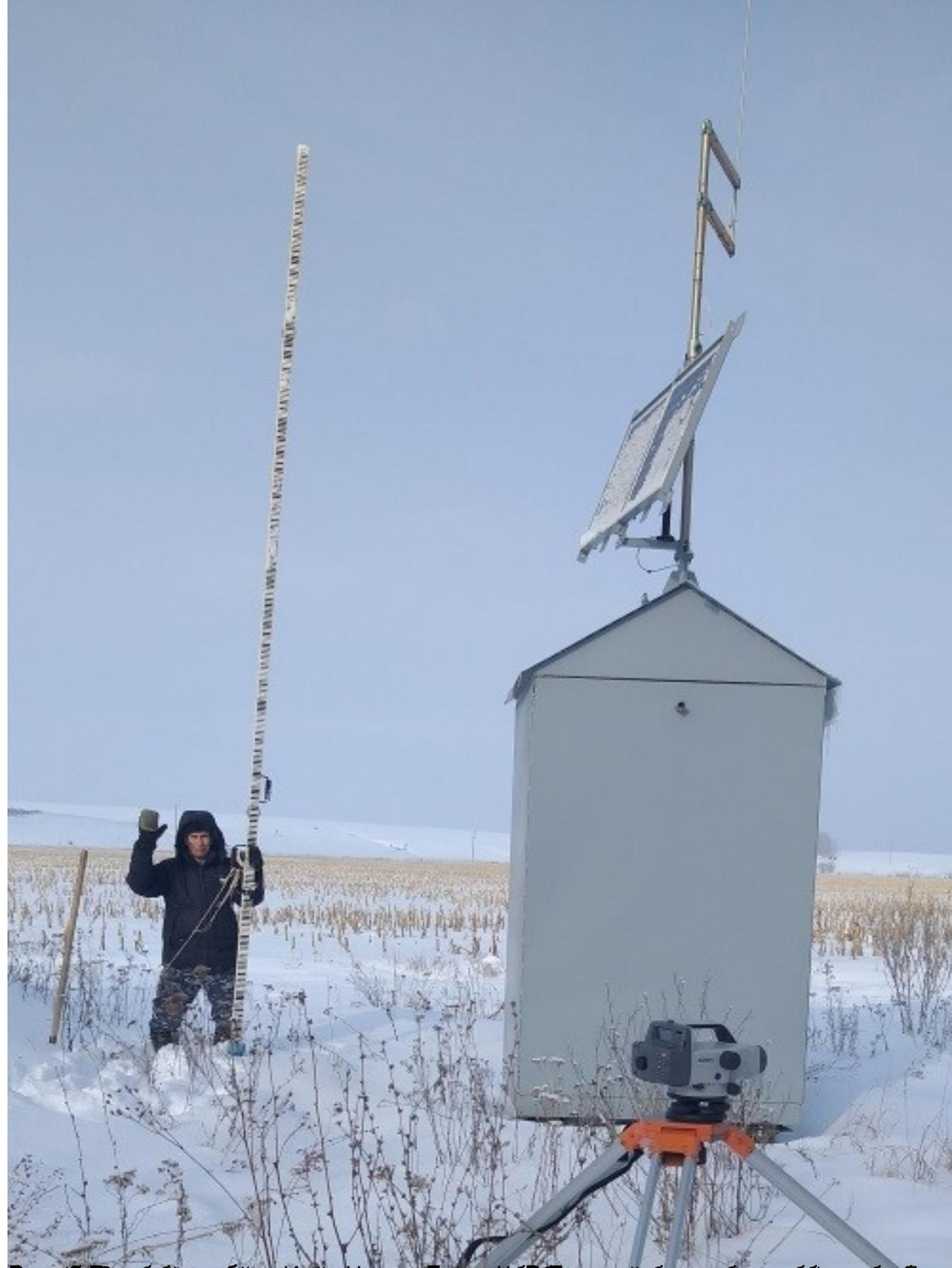
Рис. 3. Автономный гидрологический пост р. Уза-с. Чардым
